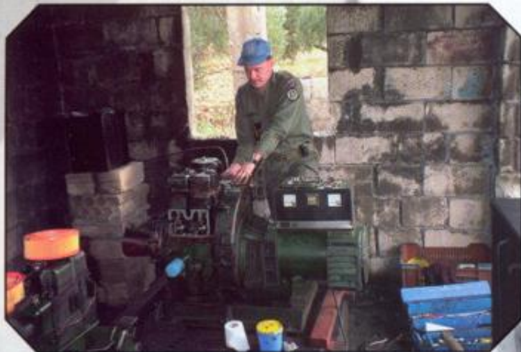
Reparasjons oppdrag i Fiji posisjon 1-14, bytte av topplokks-bolt og mutter ved fenrik Haakon Jacobsen. (foto: Frode Instefjord)
